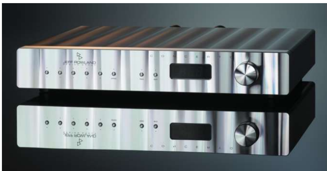
Il Concerto preamp è un oggetto molto versatile e costruito secondo la "solita" filosofia Jeff Rowland. Telaio ad H non risonante, configurazione dual mono e ingressi sia bilanciati che sbilanciati.
